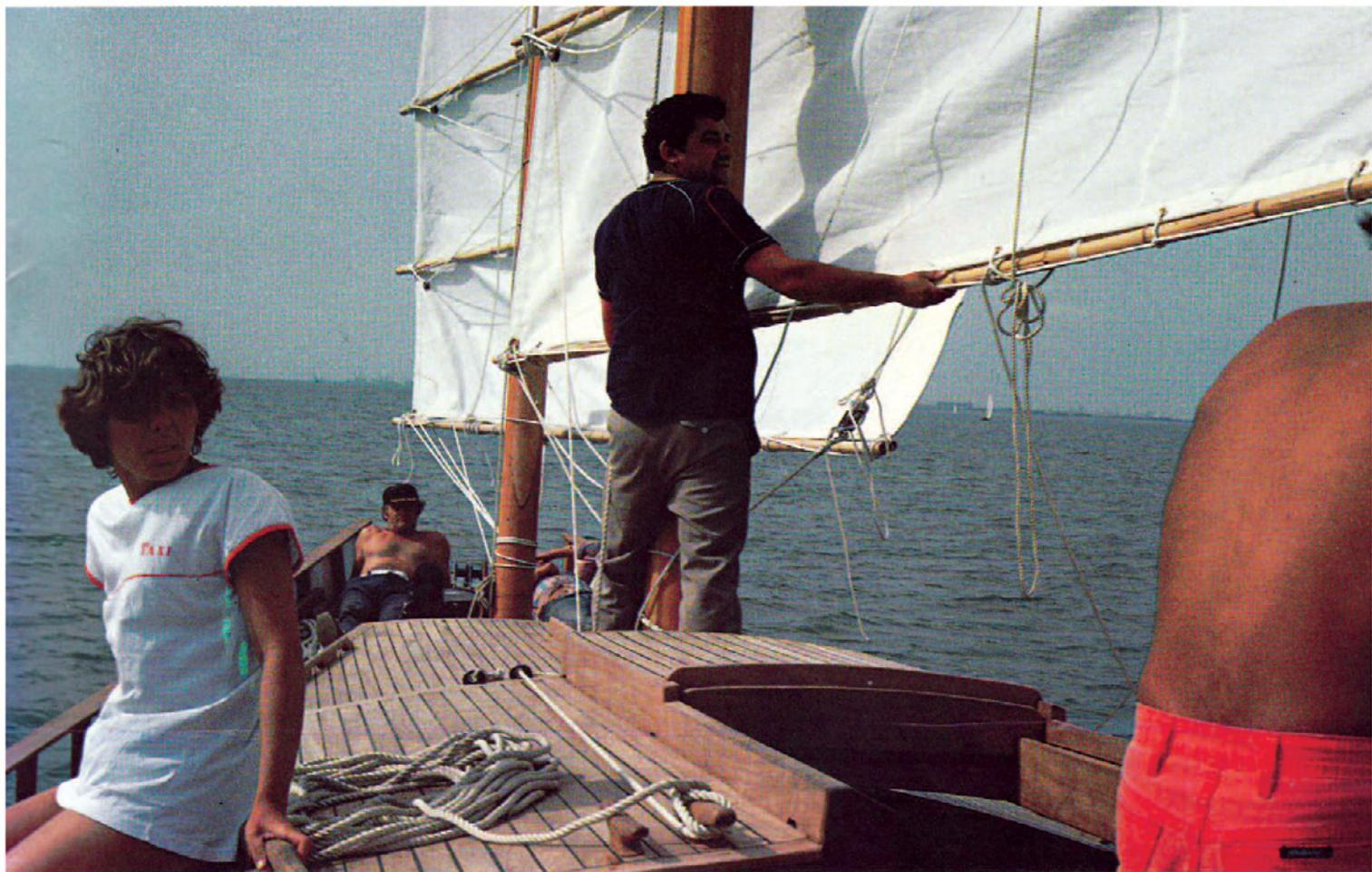
**La voile de jonque ne doit pas être creuse mais plate de façon à ce que les bambous se cintent suivant la force du vent.**
